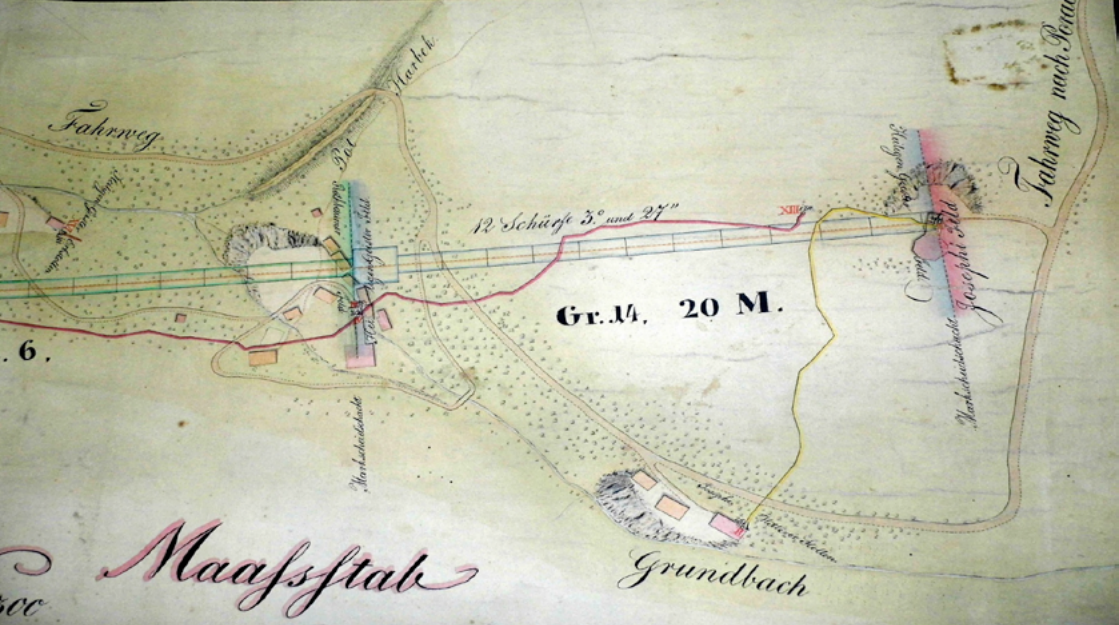
Pôdorysná mapa oblasti jamy Spoločná a Jozef z r. 1844 doplnená 1850 Žltá – priebeh Strednej Jozef štólne do jamy Jozef (ŠÚBA ŽBNV inv.č. 1952)
